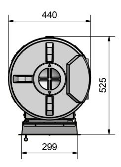
Verbrennungsluftdurchmesser = 125 mm Position seitlich, hinten, oder unten wählbar
